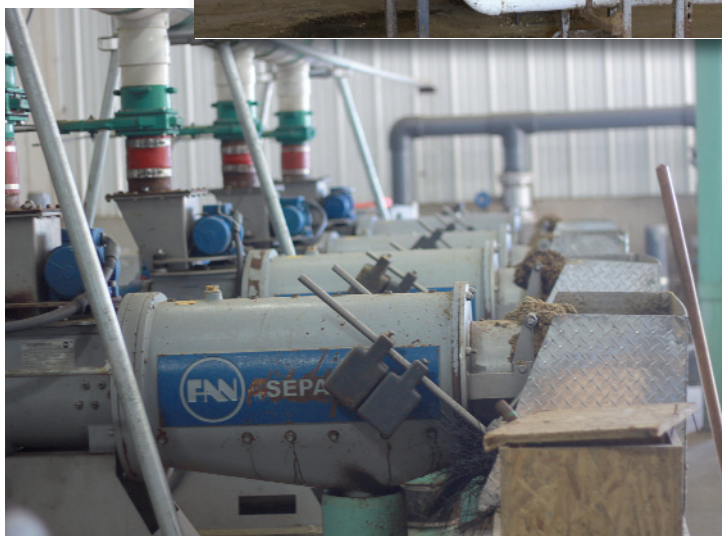
Separadores de estiércol; para abaratar los costes de adquisición se puede instalar un separador con la capacidad necesaria para producir los SER requeridos en el encamado, en lugar de procesar todo el estiércol producido en la granja
